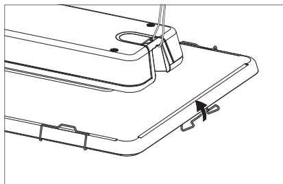
Fig. 13: Fissaggio del vetro di protezione.
